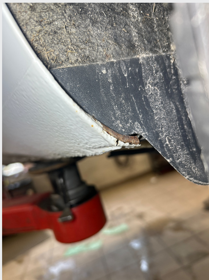
2.4 Rust i kanal venstre side
