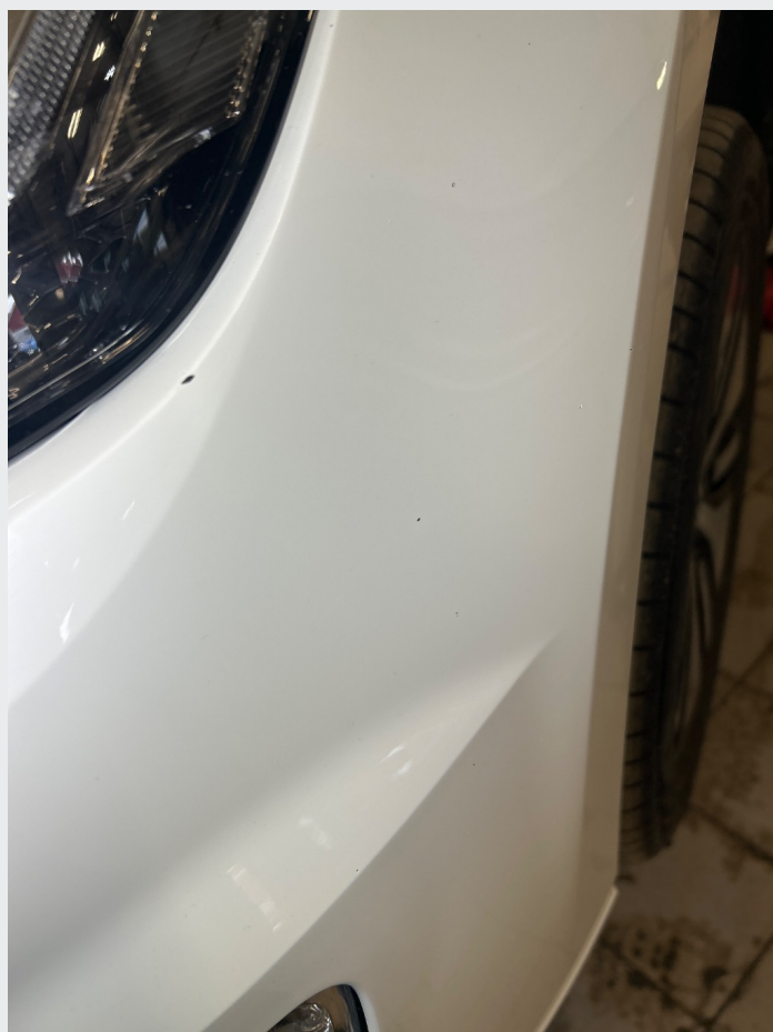
2.8 Noe steinsprut på framfanger
