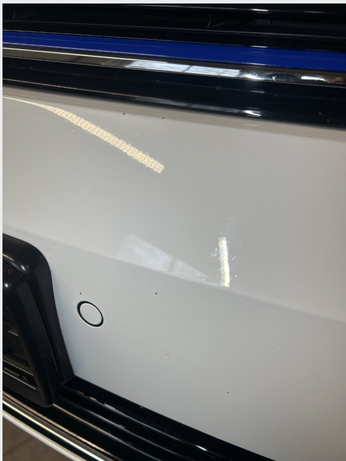
2.8 Noe steinsprut på framfanger
