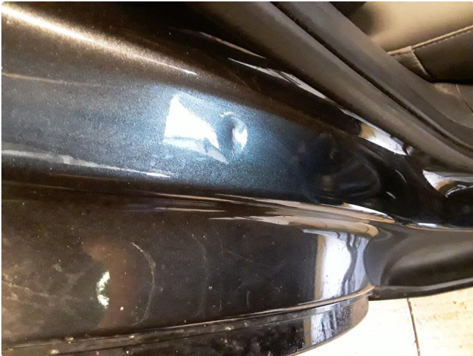
1.2 Bulk(er) med lakkskade
