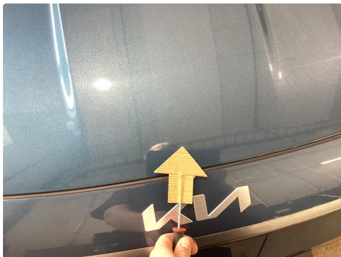
1.1 Riper og avskallinger i lakken. Dårlig passform på panseret på førerside.
