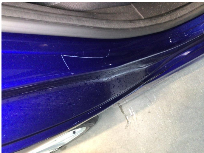
1.1 Riper i døråpning ved høyre bakdør blir utbedret med smart repair
