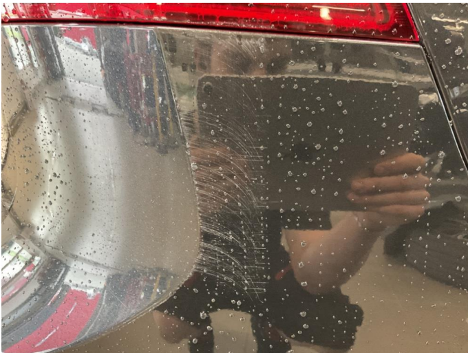
1.2 Plastrep og hellakking ( ripe på bakfanger ). Poleres bort
