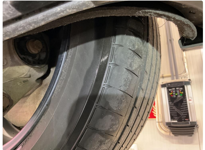
1.1 Skjev slitasje på sommerdekk ( hjulstillingskontroll utføres).
