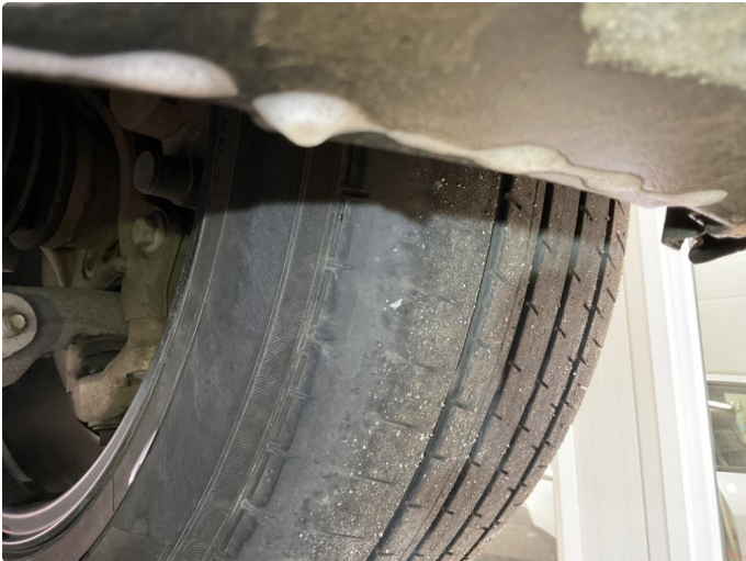
1.1 Skjev slitasje på sommerdekk ( hjulstillingskontroll utføres).
