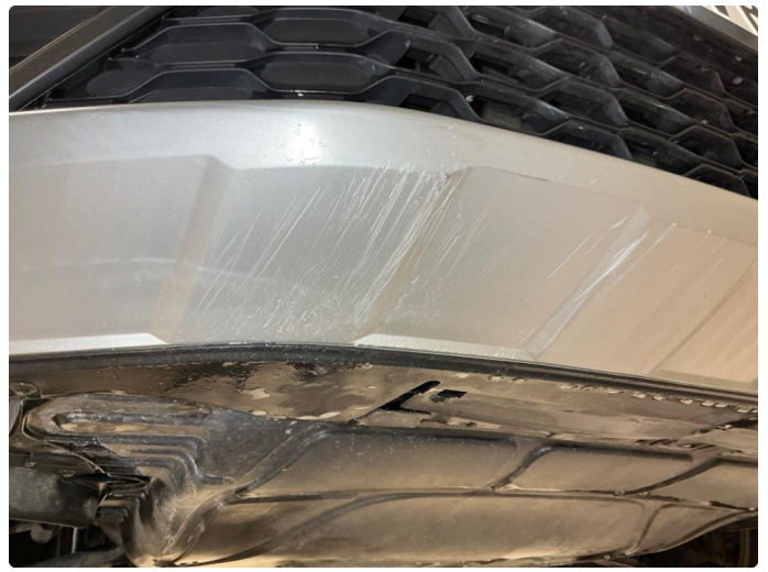
1.7 Støtfanger foran, skrubbskader underkant
