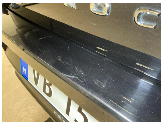
1.6 Innlasting bakfanger - riper og mekanisk slitasje
