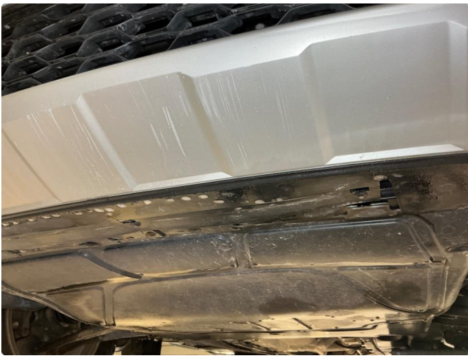
1.7 Støtfanger foran, skrubbskader underkant
