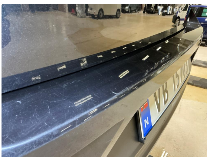
1.6 Innlasting bakfanger - riper og mekanisk slitasje
