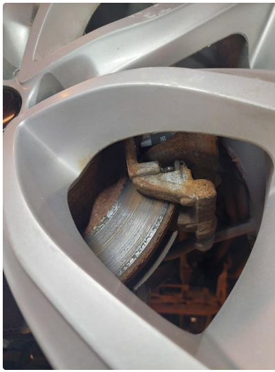
3.1 Rust, blir byttet før levering
