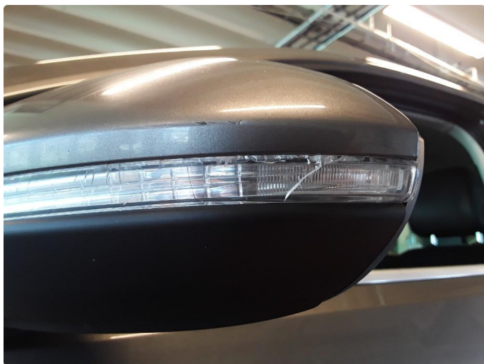
2.4 Krakelering i plast.
