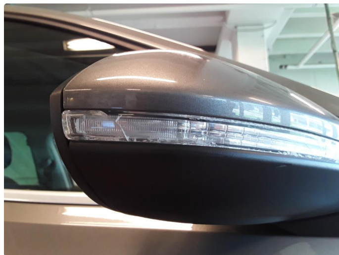
2.4 Krakelering i plast.
