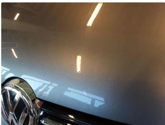
1.1 Div. stensprut, riper og lakkskader i karosseriet.
