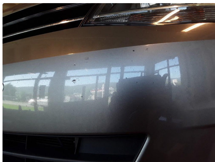
1.1 Div. stensprut, riper og lakkskader i karosseriet.
