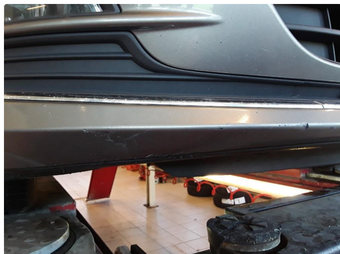
1.1 Div. stensprut, riper og lakkskader i karosseriet.
