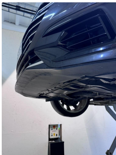
1.3 Noen riper og sår på støtfanger foran.
