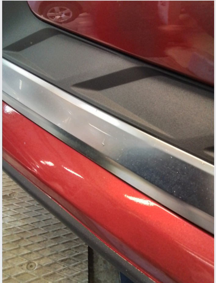
2.8 Steinsprut i kromlist nedkant begge sider frontfanger
