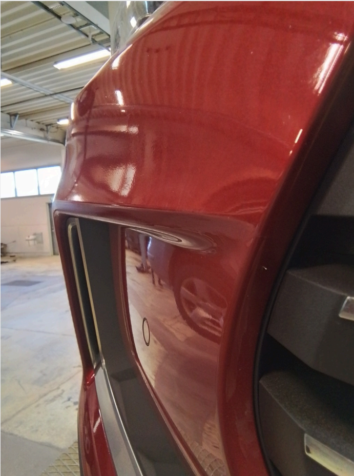
2.8 Steinsprut i kromlist nedkant begge sider frontfanger
