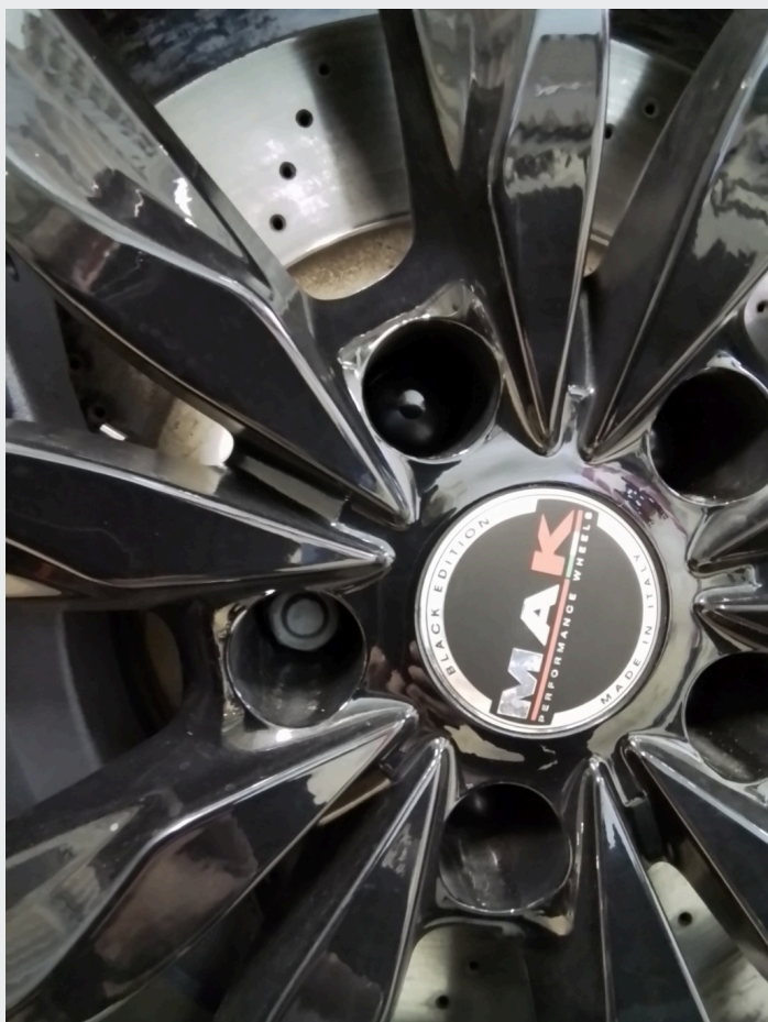
2.19 Mangler deksel over hjulmutter venstre foran
