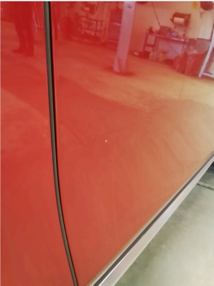
2.5 Bulk i dør høyre foran
