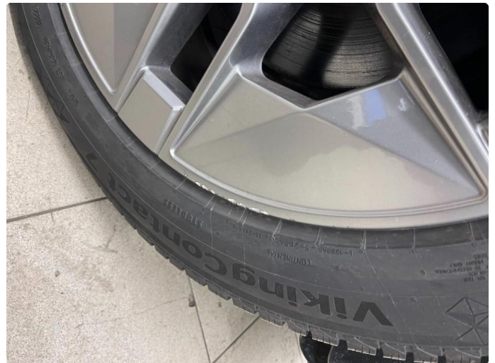
1.1 Kantkjørte felger høyre side- normal bruksslitasje
