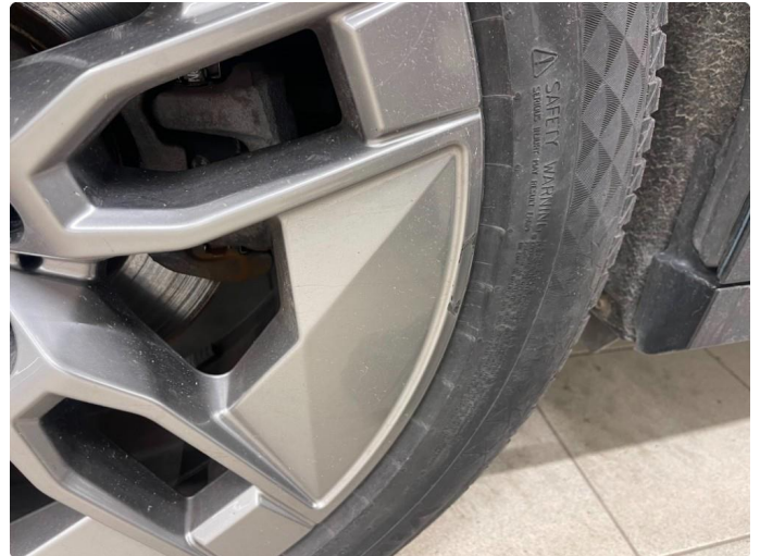
1.1 Kantkjørte felger høyre side- normal bruksslitasje
