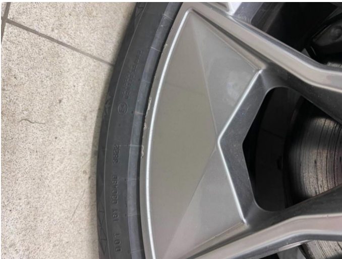
1.1 Kantkjørte felger høyre side- normal bruksslitasje
