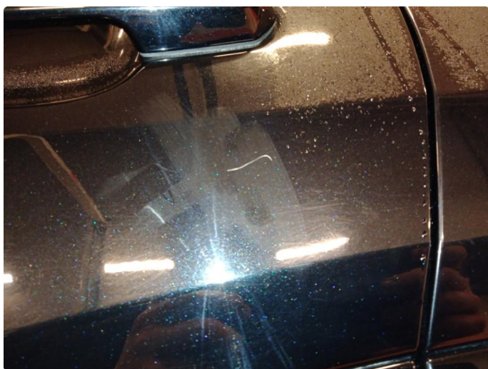
1.3 Diverse små riper. Steinsprut til grunning
