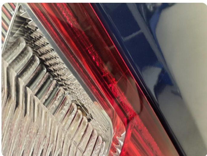
4.1 Krakelering i plast
