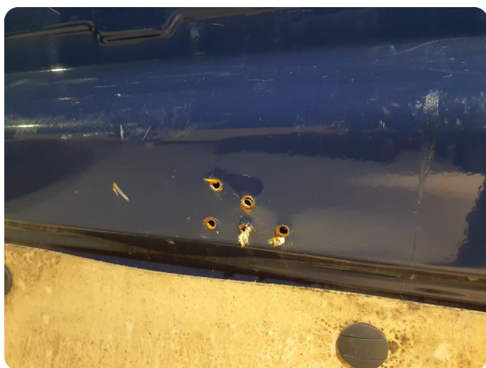
8.3 Øvrige feil Inkluderer mye riper, bulker, hull etter montert innredning. Skader på plater. Osv i hele varerom.
