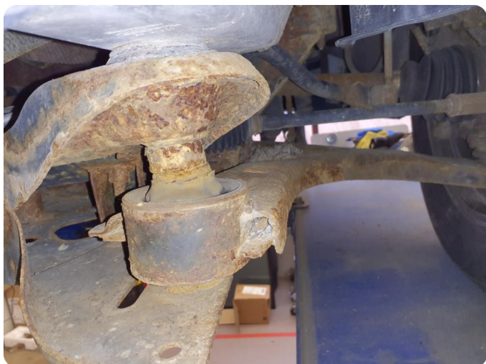
6.1 Slitt bærebruforing Bakre bæreamsforing
