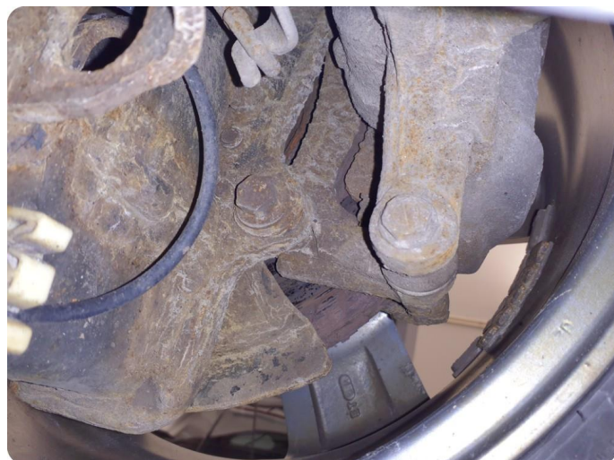
7.1 Øvrige feil Bil varsler, må kontrolleres. Foran og bak, rust og slitt
