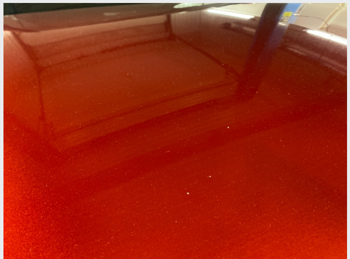
2.3 Steinsprut panser, noe er flekket
