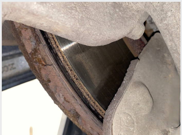
9.7 Skiver foran må påtegnes bytte ved neste klossebytte, slitekant og påbegynt rust
