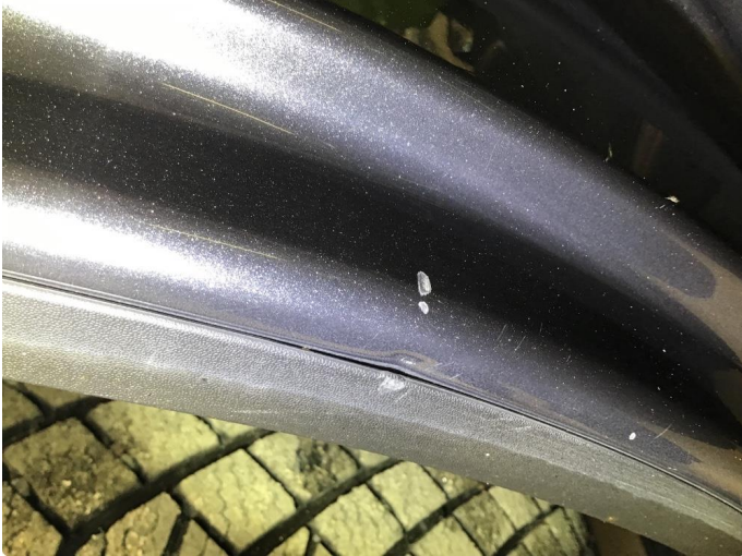
1.1 Bulk(er) med lakkskade
