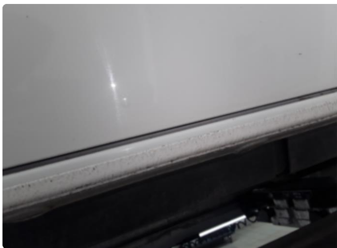
1.1 Div. lakkriper, steinsprut med korrosjon, småbulker kar. Noe riper på støtfanger bak. Liten bulk i forkant tak.
