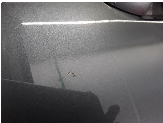
2.1 Ripe ned til grunning
