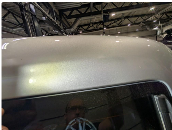
1.4 Steinsprut med rust
