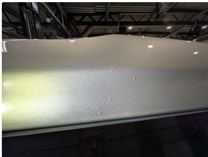
1.4 Steinsprut med rust
