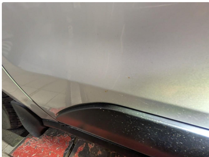
1.4 Steinsprut med rust
