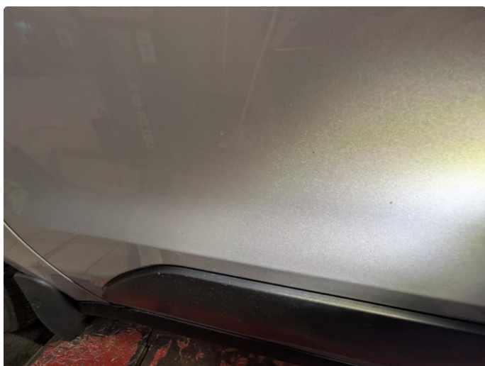
1.4 Steinsprut med rust
