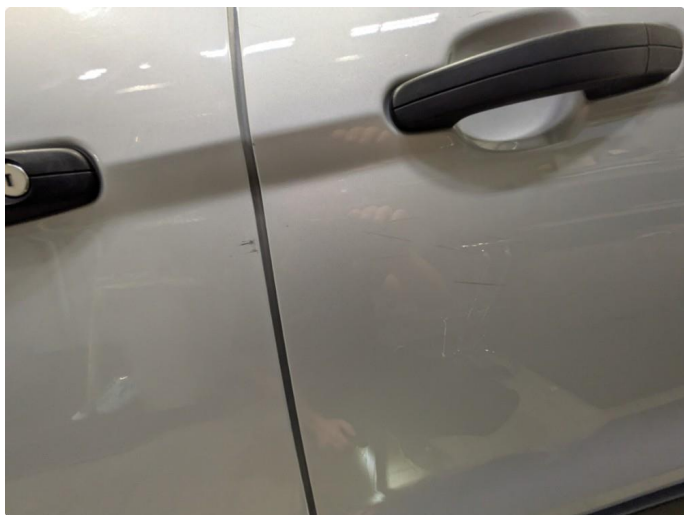
1.4 Steinsprut med rust
