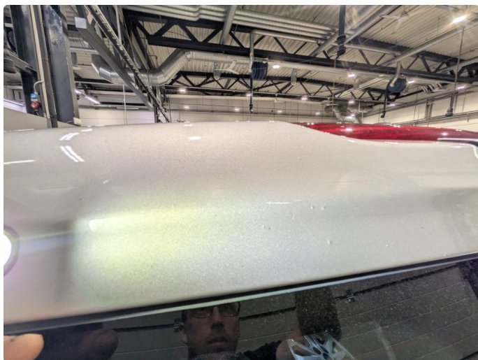
1.4 Steinsprut med rust
