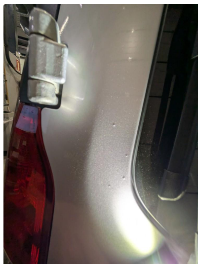
1.4 Steinsprut med rust
