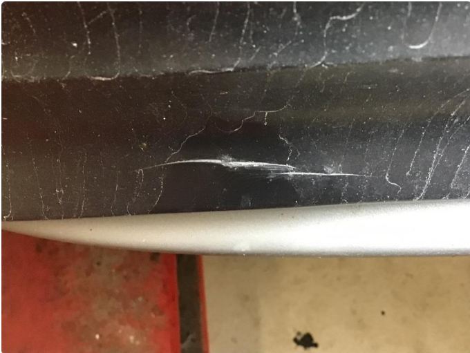
1.1 Liten skade i plast på støtfanger
