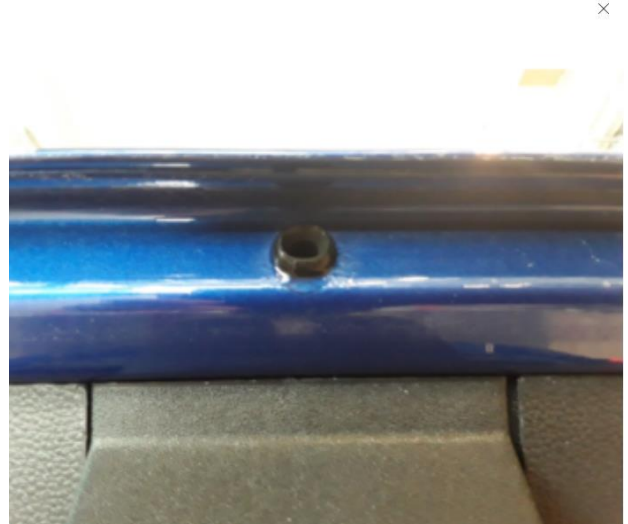
1.2 Noe korrosjon bakluke.
