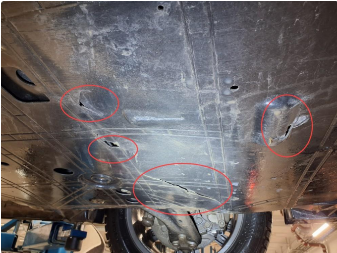
1.1 Deksel under skadet.
