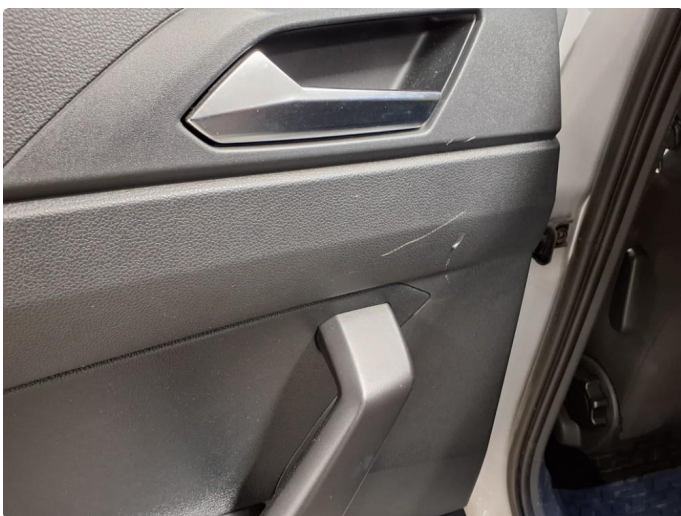
2.1 Skadet/merker etter utstyr
