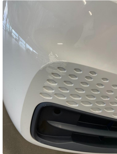
1.2 Riper høyre side frontfanger (tettet med lakkstift)
