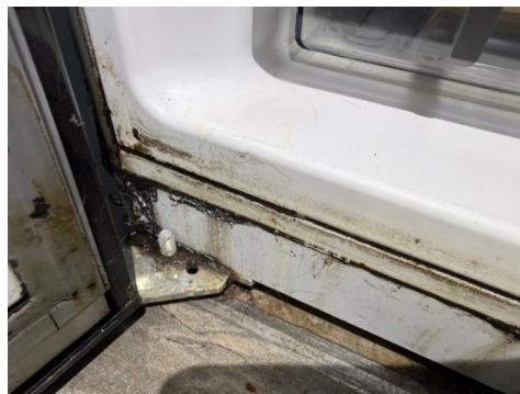
Lekkasje fra kjøleskapet
