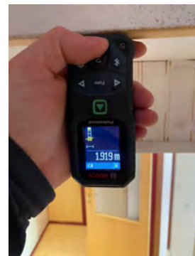
Frihøyde i trapp er målt til ca. 1.9 m.
