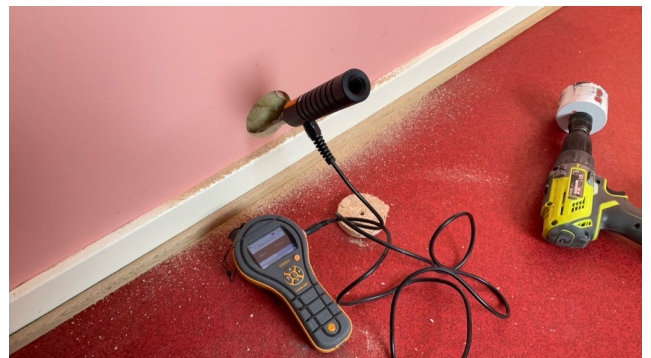
Ingen unormale forhold påvist ved hullboring i tilstøtende vegg til badet.
