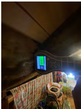
Fuktmåling i takkonstruksjon viste ingen forhøyede fuktverdier.
