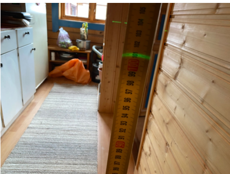
Måling av planavvik
