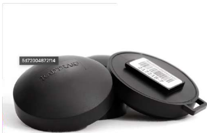
Eksempelbilde sporfilm for måling av radon.
