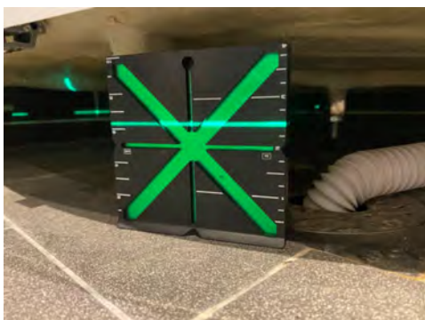
Måling av fallforholdt til sluk.
