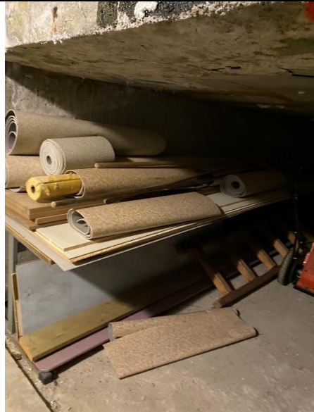
Plassering: Renserom under svømmebasseng Materialtype: Vinylgulvbelegg i ruller
