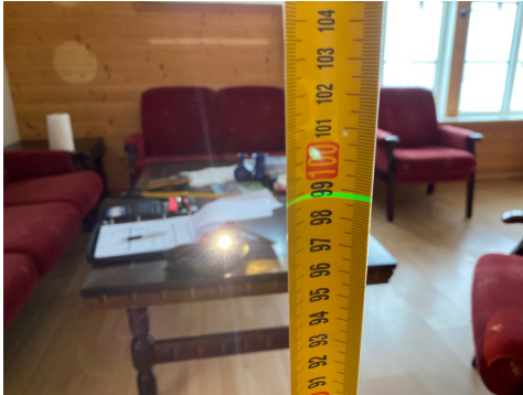
Måling av høydeforskjell, stue.
