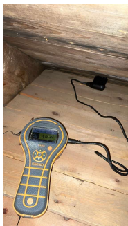
Forhøyede fuktverdier måles lang raft
