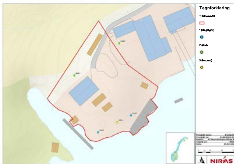
Figur 11: Tilstandsklasse kartet viser en oversikt over forurensningssituasjonen fra dypereliggende jord (>1 m) innenfor tilstandsområdet ved Hitterveien 24, 7246 Sandstad. Analysedataene er sammenlignet med tilstandsklasse grenser og fargekodet i henhold til Miljødirektoratets tilstandsklasser [4].
