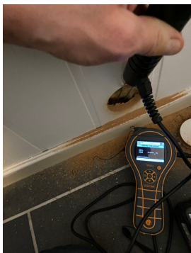
Bildet viser hulltaking/fuktmåling, uten avvik.
