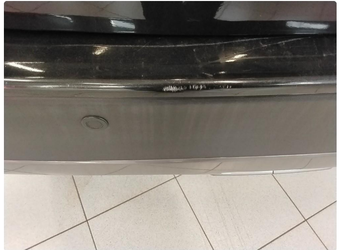
1.2 Små striper innlasting bakluke. Er trukket med blank plastikk beskyttelse.
