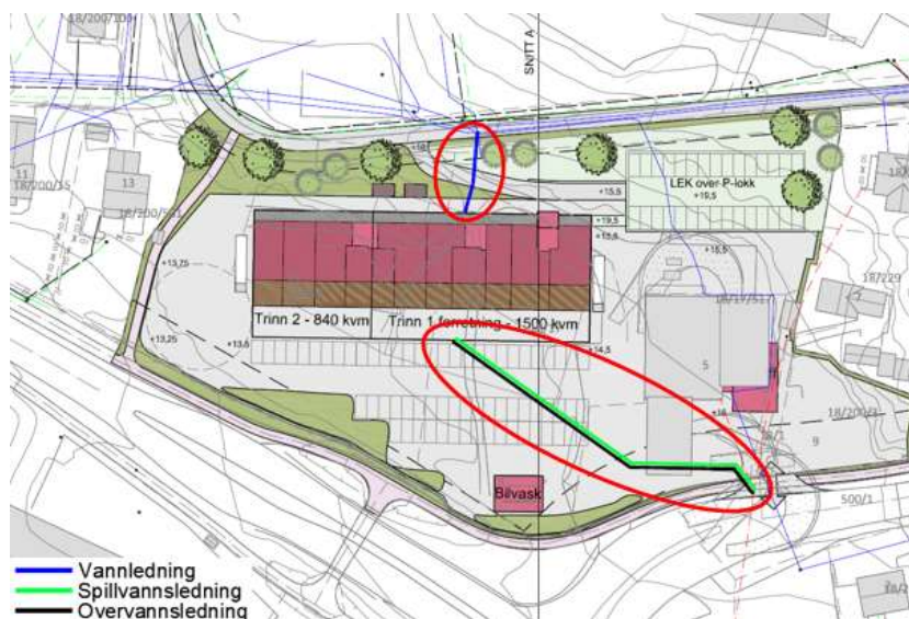
Figur 26. Forslag til nye VA-ledninger fra nytt bygg.
