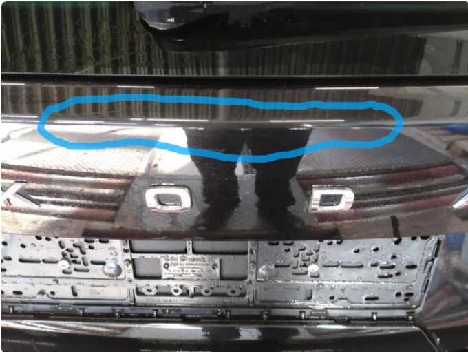
1.1 Ripe(r) ned til grunning
