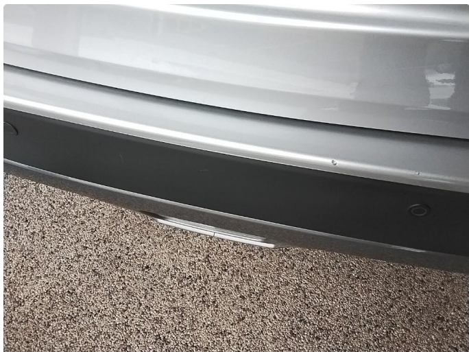
1.1 Små hakk ved innlasting bagasjerom.
