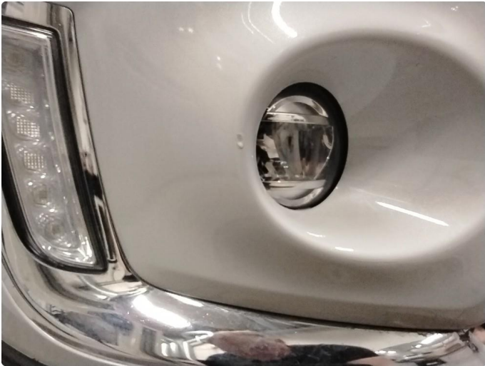
1.2 2 små steinsprut , flikket i.
