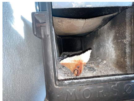
Sprekk i topplate inne i ovn
