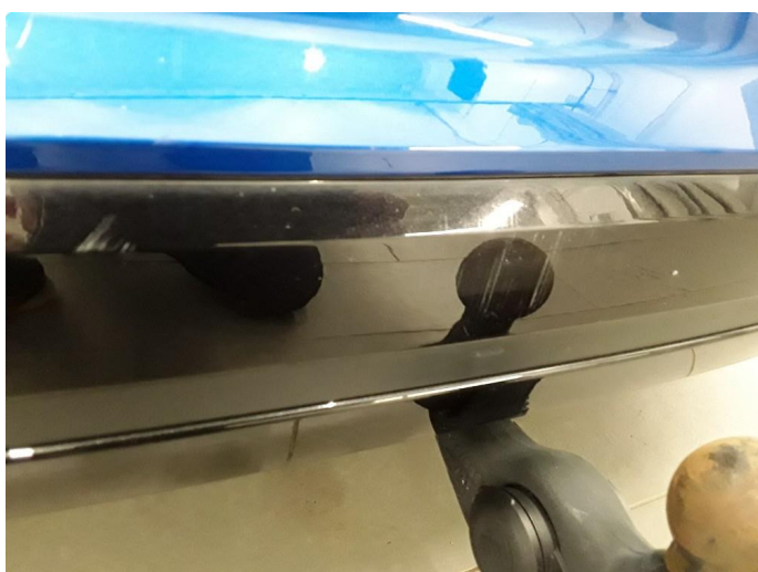
1.3 Noe små innlastningsriper på støtfanger bak. Normal bruksslitasje
