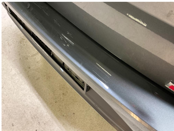
1.9 Støtfanger bak - riper og mekanisk slitasje
