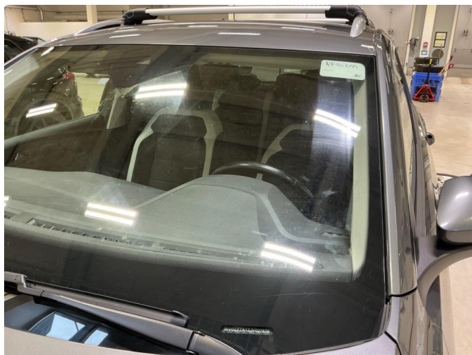
1.10 Slitasje/riper i frontvindu -
