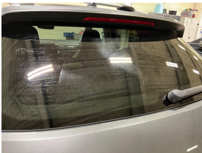
1.11 Mekanisk slitasje fra visker - bakvindu
