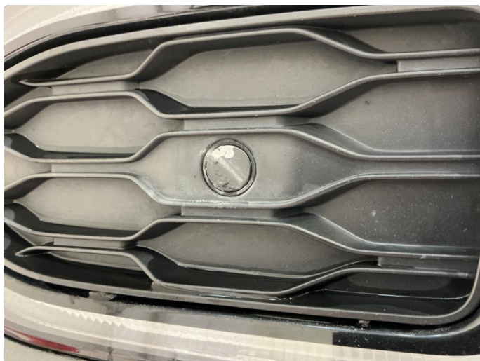
1.8 P-sensor venstre side foran flasser
