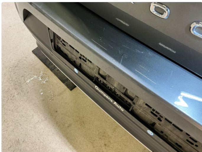
1.9 Støtfanger bak - riper og mekanisk slitasje
