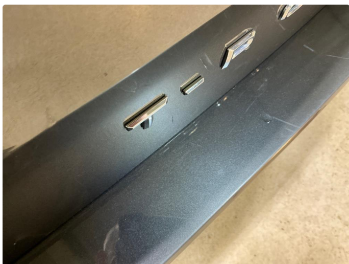
1.9 Støtfanger bak - riper og mekanisk slitasje
