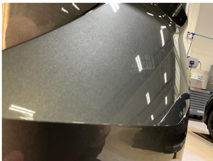
1.9 Støtfanger bak - riper og mekanisk slitasje
