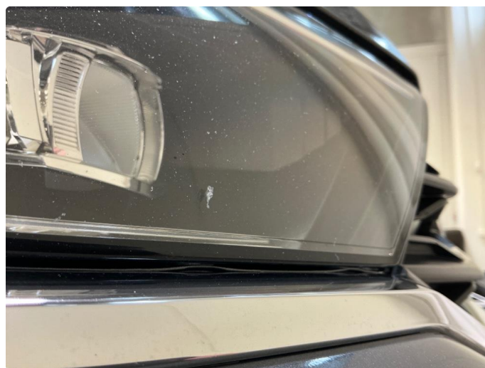
2.1 Steinsprut høyre frontlykt
