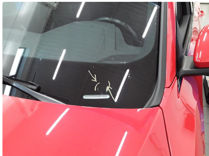
1.2 Steinslag m/sprekk. Time for rutebytte bestilt.
