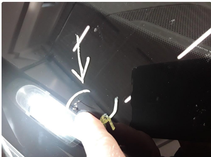
1.2 Steinslag m/sprekk. Time for rutebytte bestilt.
