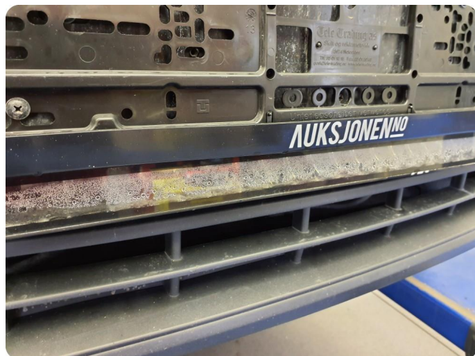
4.1 Øvrige feil Dugg/fukt ledbar
