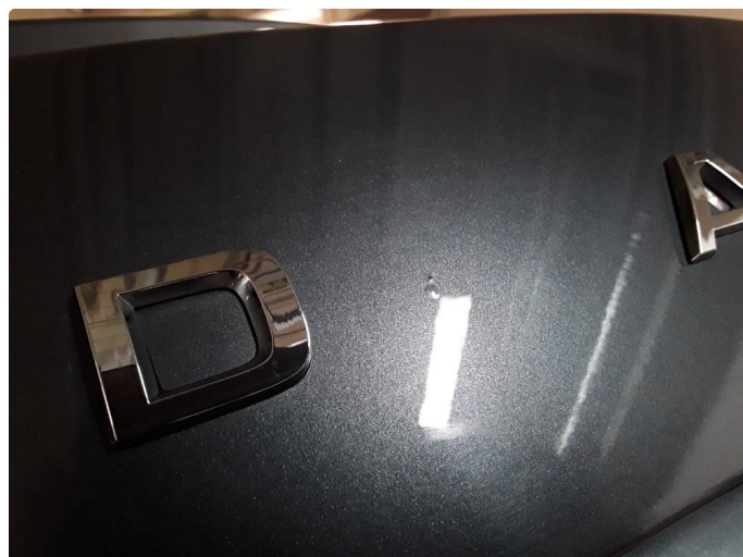
1.3 Steinsprut med korrosjon.
