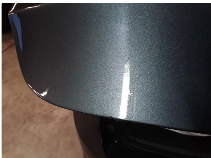
1.3 Steinsprut med korrosjon.
