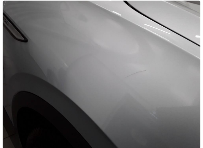
1.2 Ripe på høyre forskjerm. Polering forsøkes.
