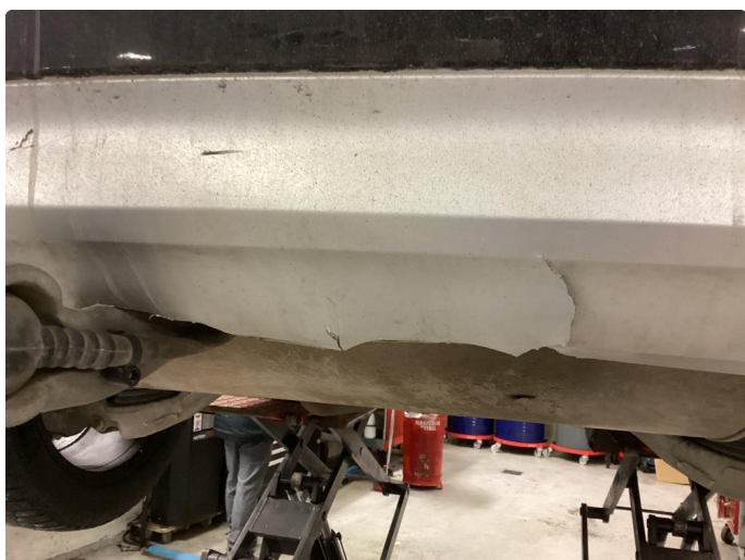
1.3 Skade lett under fanger bak
