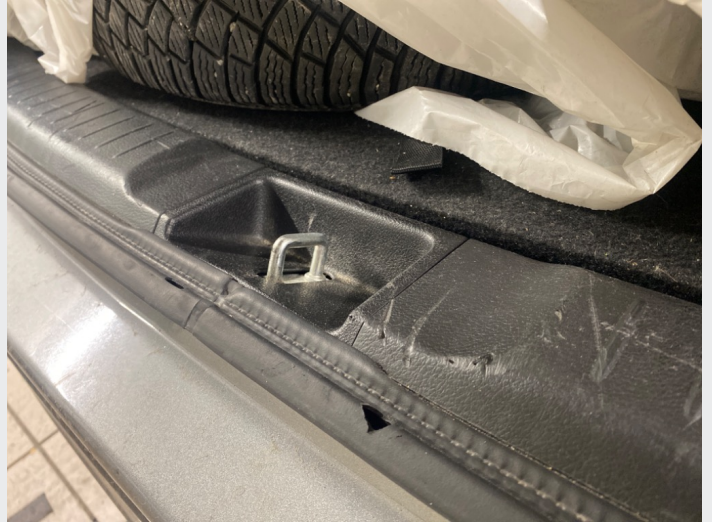
4.7 Skadet "innsteg" bakluke
