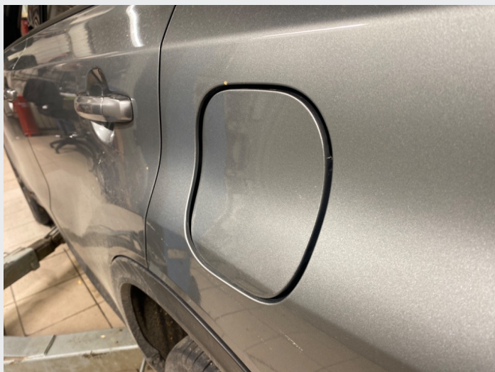
2.7 Tanklokk trykt inn, tar borti skjerm når det åpnes
