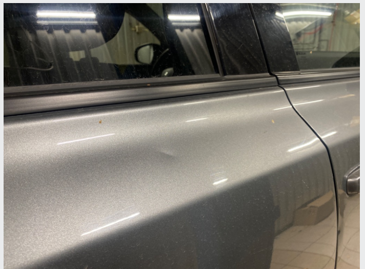
2.5 Bulk høyre bakdør
