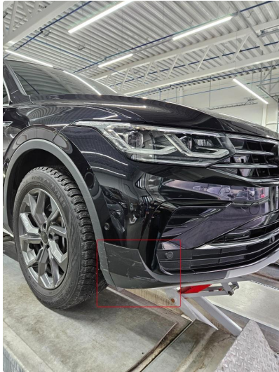
1.1 Skrubbermerker/riper nede på ulakkert plast/støtfanger h.side foran
